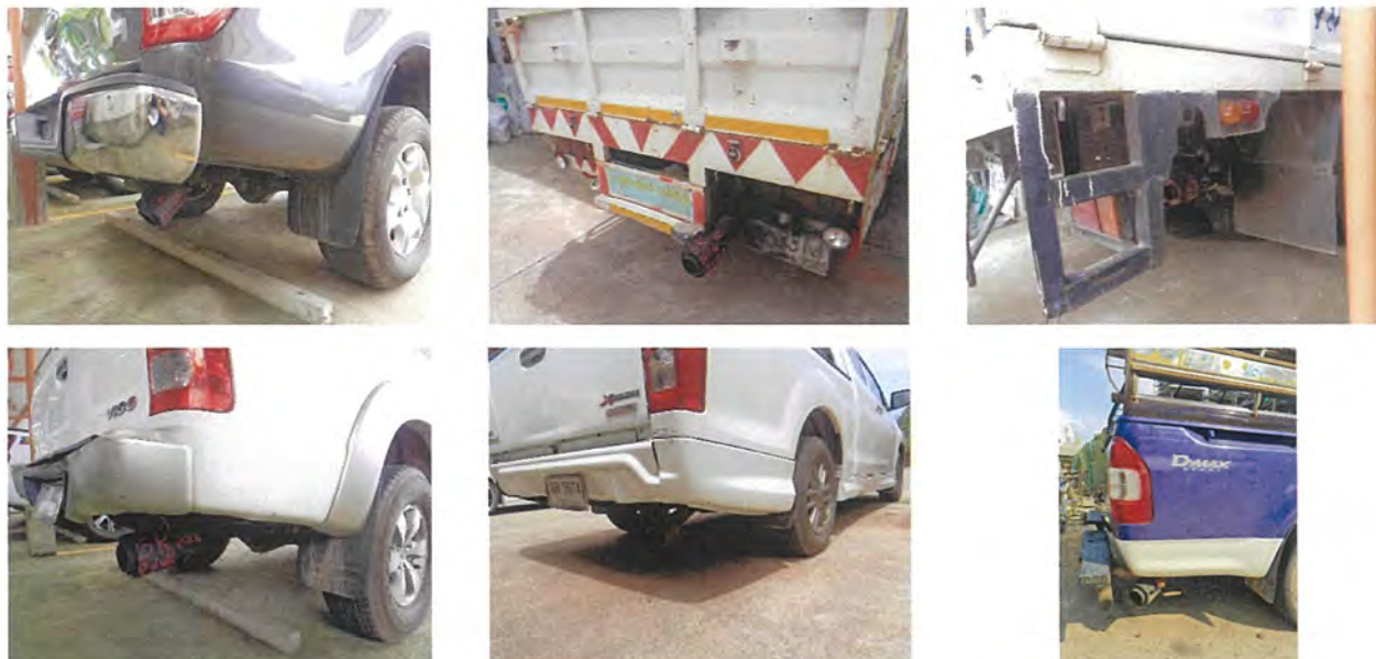
ภาพที่ 2.2-43 รถของผู้รับเหมามีการติดตั้งอุปกรณ์ป้องกันประกายไฟ
