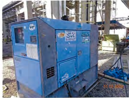
ภาพที่ 2.2-9 อุปกรณ์ปิดครอบเครื่องจักรเพื่อลดระดับเสียงดัง
